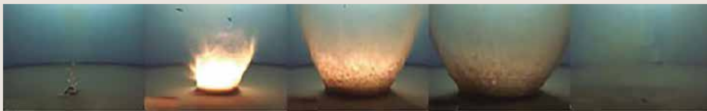
Figura 6. Cráter generado por una explosión a escala de laboratorio.
