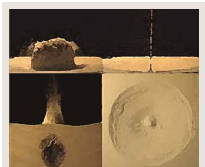
Figura 7. Cráter y chorro granular generado por el colapso de una cavidad presurizada.
