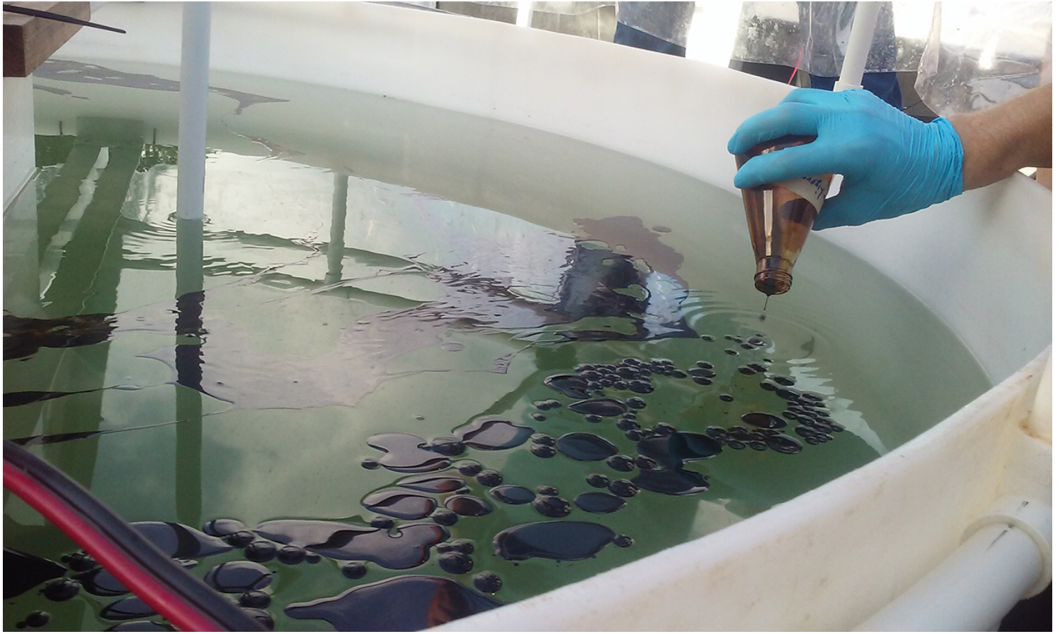
Fig. 2 Experimento de degradación de hidrocarburos a meso-escala (2500 litros), con agua marina proveniente del Golfo de México.
